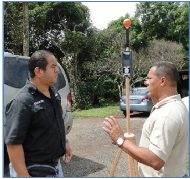
Medición de Radiaciones No Ionizantes y monitoreo continuo de RNI
