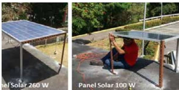
*Paneles PV de 260 W y 100 W instalados y expuestos a condiciones climáticas en tiempo real. Estación de La Colina*
