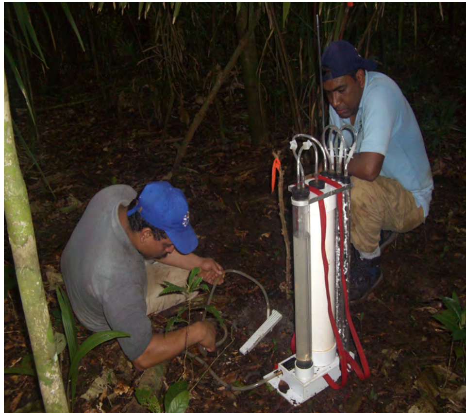
Pruebas de medición del tiempo en que el suelo absorbe el agua , realizada en Barro Colorado
