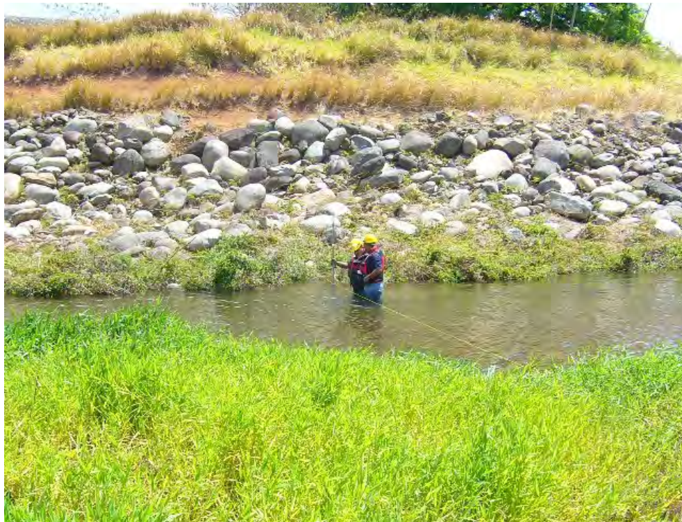
Aforo por vadeo en Presa Barrigón, Aguas Abajo
