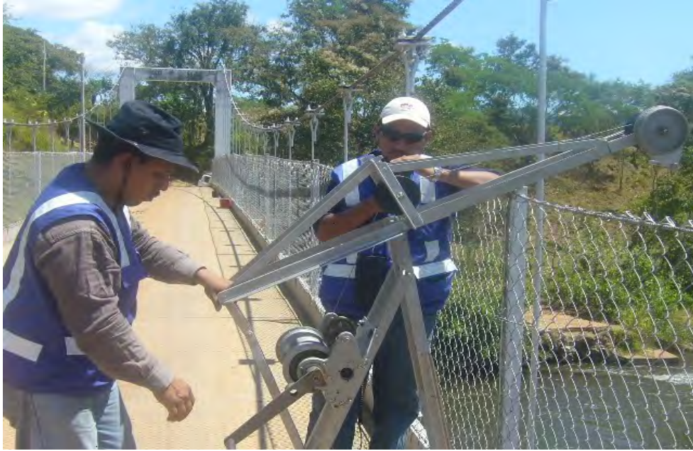
Aforo de suspensión en presa Chiriquí
