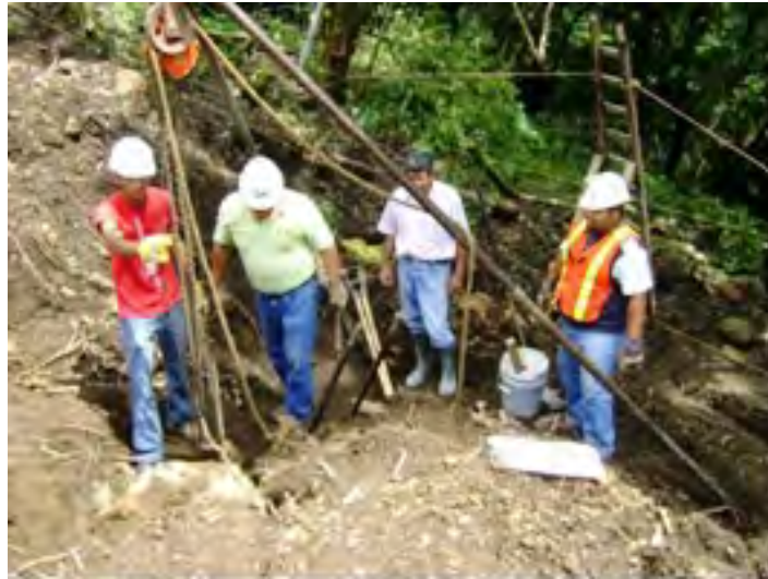
Prueba de percolación para proyecto residencial en Volcán, Chiriquí
