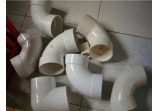
Materiales y piezas de PVC y para cambio de sistemas de tuberías en los estanques de las estaciones
