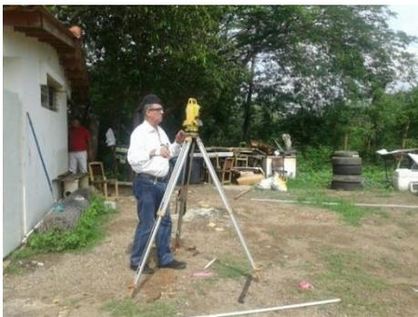
**Figura 9.** Medición de los puntos por parte del topógrafo para la construcción de la unidad experimental.
