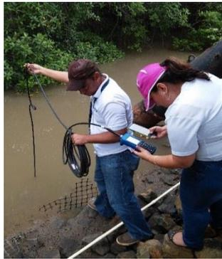
**Figura 7.** Toma de Muestras de agua y medición de Parámetros con sonda HL4.
