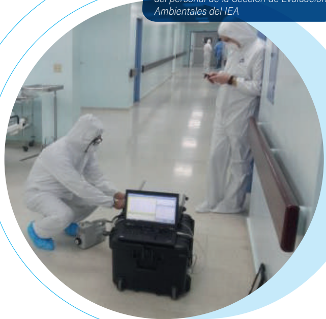
Medición de compuestos orgánicos volátiles en el Hospital San Miguel Arcángel a solicitud del Ministerio de Salud por parte del personal de la Sección de Evaluaciones Ambientales del IEA
