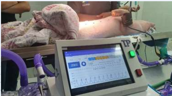
Prototipo del Ventilador Artificial UTP - 100 P y pruebas en cerdos
