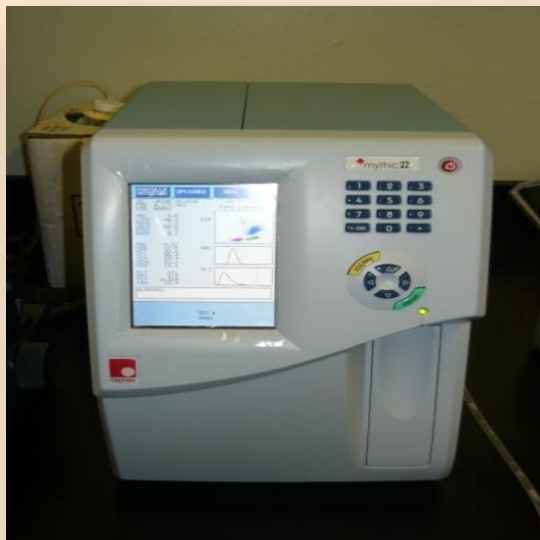
Mythic 22 analizador Hematológico de 22 parámetros diferencial de 5 partes
