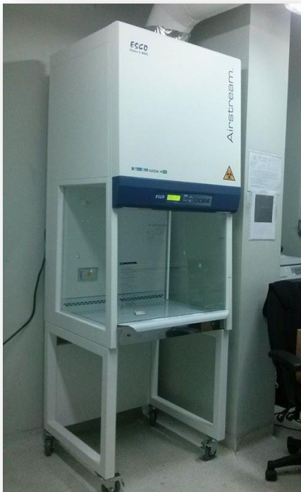
Cabina de Bioseguridad para separar alícuotas de muestras
