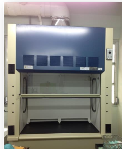
Cabina de extracción de gases tóxicos que debe proveer un flujo de aire suficiente para extraer y evitar la inhalación del operador.
