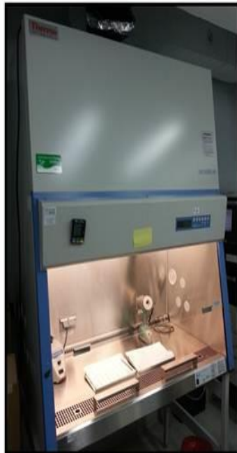
Cabina de Bioseguridad tipo A2: Utilizada para la siembra de muestras que llegan para diagnóstico, realización de pruebas bioquímicas para la tipificación de micobacterias, realización de las pruebas de sensibilidad por diferentes métodos y cualquier análisis de muestra o cepa que llegue a la sección de Micobacteriología
