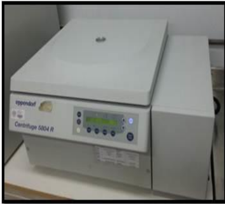
Centrifuga refrigerada usada para la descontaminación de las muestras para cultivos por micobacterias
