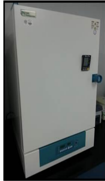
Horno de Aire Forzado (de uso en la coagulación de medios de Lowenstein-Jensen u otros medios a base de huevo)
