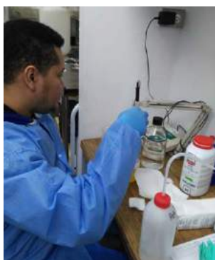
Técnico Asistente de Laboratorio Clínico, Gadir Herrera, utilizando el pHmetro, para medir el pH de los medios a preparar.
