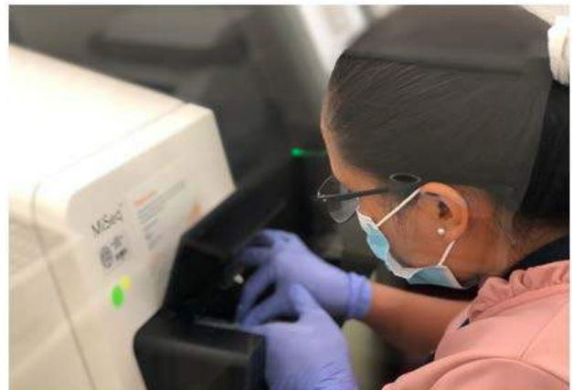
Procesamiento de muestras utilizando la tecnología de Secuenciación de Próxima Generación ("NGS"). La colaboradora Licda. Marggie Rodríguez realizando el proceso de evaluación de la calidad de las librerías de NGS y secuenciación utilizando el Secuenciador MiSeq de Illumina. (Departamento de Investigación en Genómica y Proteómica).
