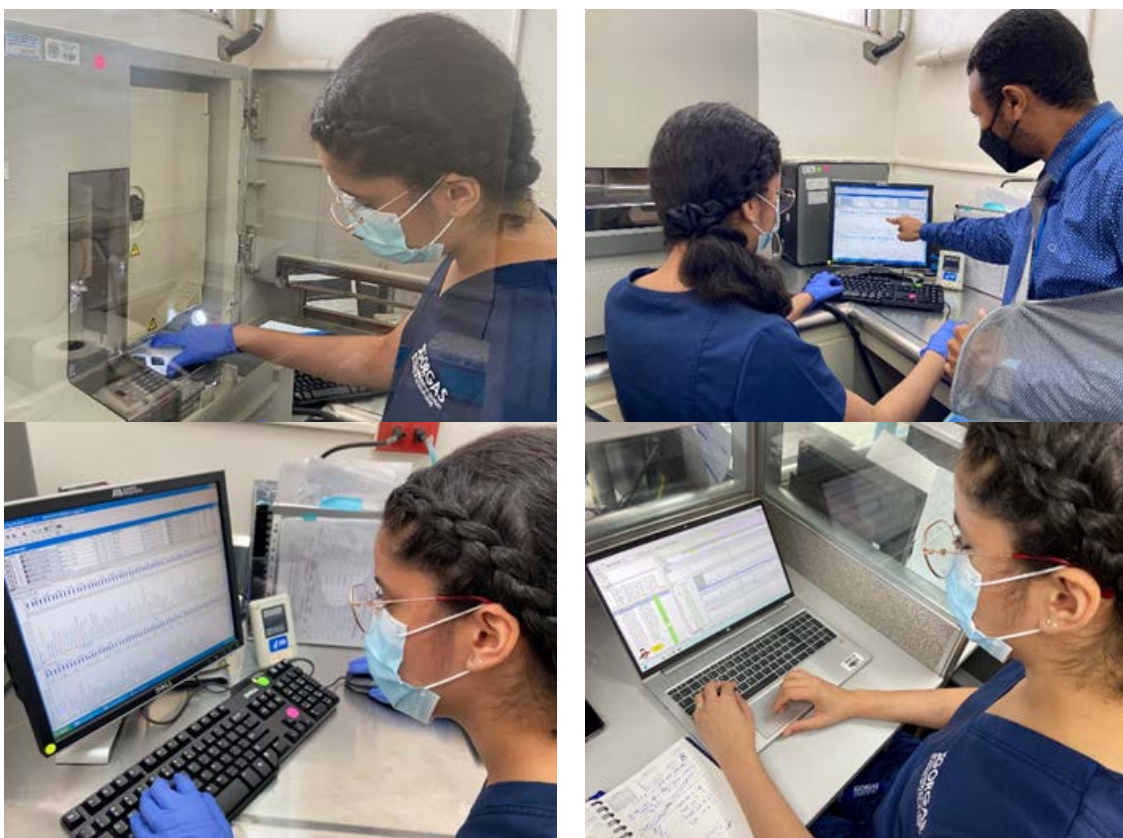
Secuenciación y análisis de datos de secuencia de alelos HLA. En las fotos se muestra a la colaboradora Ana Cristina de Martínez, realizando la secuenciación capilar de las muestras, Amplificación de ADN y el Análisis de los datos crudos de secuencia utilizando el software del equipo Sequencing analysis y por último la asignación de alelos HLA utilizando el Software uType.
