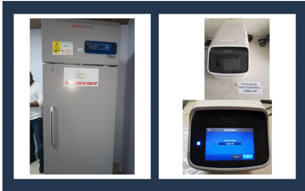
En la sección de la izquierda se observa equipo para almacenamiento de muestras moleculares, tejidos y material biológico (congelador -20); a la derecha se observa un termociclador para amplificación de genes.
