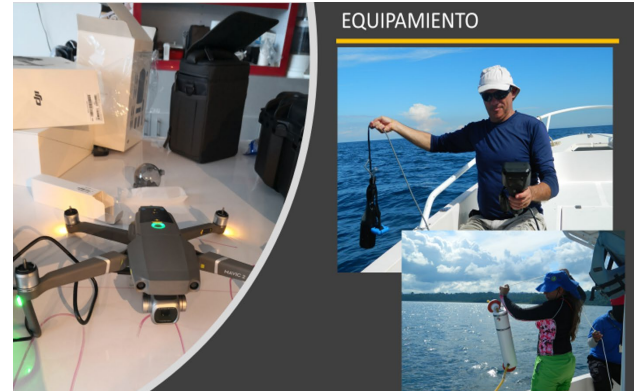
Algunos equipos de monitoreo adquiridos: drone, sonda de monitoreo oceanográfico de parámetros fisicoquímicos, botella colectora VanDorf.
