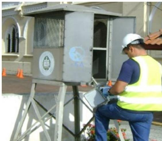
*Proceso de recolección de muestras de aire en el Equipo Muestreador para partículas de aire*
